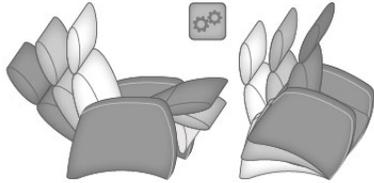
Stufenlose, synchrone Verstellung der Beinauflage und Rückenlehne durch einen Elektromotor mit zusätzlicher Aufstehhilfe (max. 110kg).
