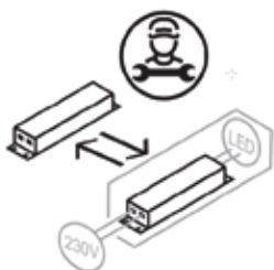
Betriebsgerätetausch durch Fachmonteur
