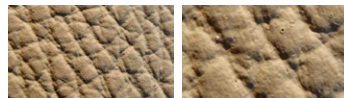
Pigmentiertes Glattleder: Seine Poren sind nicht mehr erkennbar, eine dicke Farbschicht wurde auf das Leder aufgetragen
